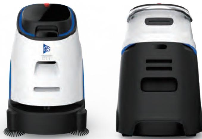
**VACUUM 40** は本格的な清掃ロボットで吸引と掃き掃除の両機能を搭載しており、労働時間節約、及びコスト削減が実現可能です。床全般、及びカーペットに対応しております。強力な清掃性能と高い安全性を備えているため、オフィス、ホテル、商業施設、空港等ありとあらゆる屋内箇所に合致しております。
